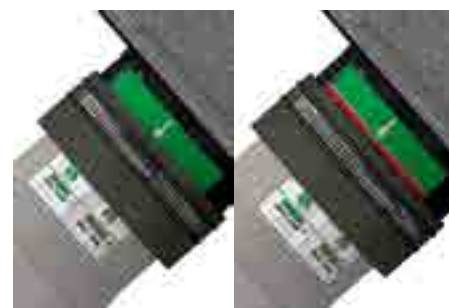
6. Отточната тръба се свързва с таблета на барбакана, докато се скрие червената ивица
